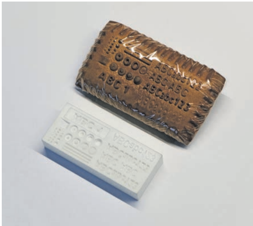
Kunststoffmodell für die Prägung von Biber. Verschiedene Höhen und Tiefen wurden getestet.
